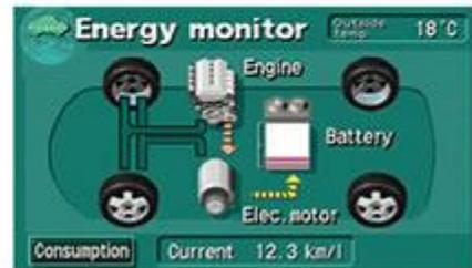
Si el conductor selecciona la función de máxima retención con el mando del cambio, el motor térmico gira sin alimentación de combustible (es decir, se convierte en una bomba de aire). En esa posición del cambio, además, la retención que da el motor eléctrico convertido en generador también es mayor.
