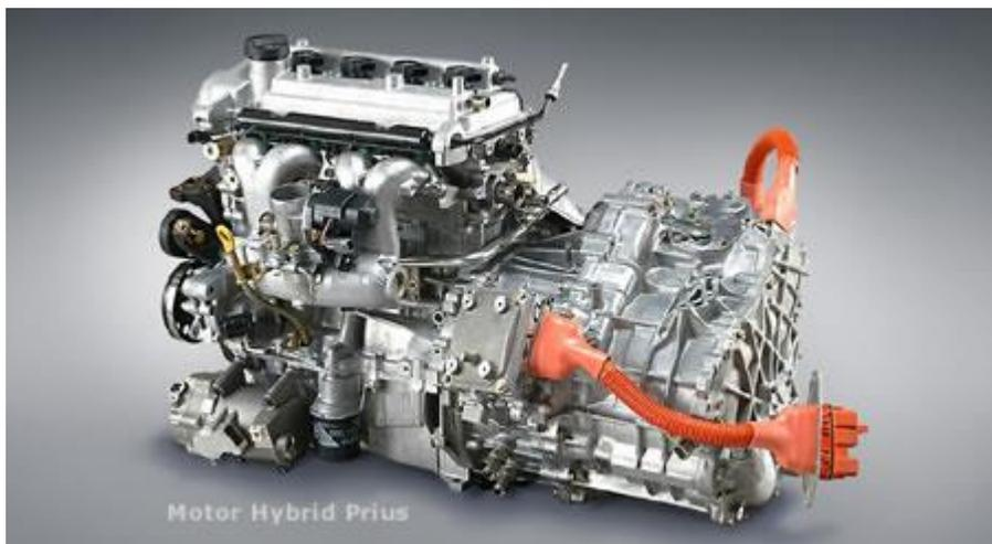
El Prius tiene un motor eléctrico permanentemente engranado al diferencial de la transmisión, sin ningún tipo de embrague. Es decir, el motor eléctrico y las ruedas son siempre solidarios. El funcionamiento del motor eléctrico es posible durante unos pocos km y por debajo de 50 km por hora y esto suponiendo que la batería este a plena carga, porque sino la autonomía sería mucho menor..
