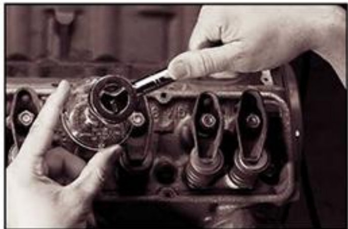
Indicador de Torsión-por-Ángulo (Parte Número TRQ-1)
